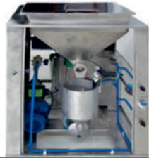
Çamaşır Makinesi Merkezi Tez Dozaj Sistemi
